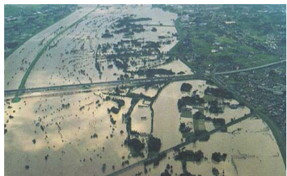
荒川の洪水(1999年9月) ダム地点の計画高水量毎秒1,850m 3 のうち1,550m 3 をダムで調整し、ダム下流域の洪水被害の軽減をはかります。
